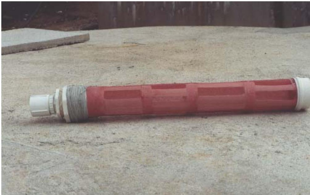
**Figura 15.** Ilustração fotográfica do filtro para o tanque de equalização.
