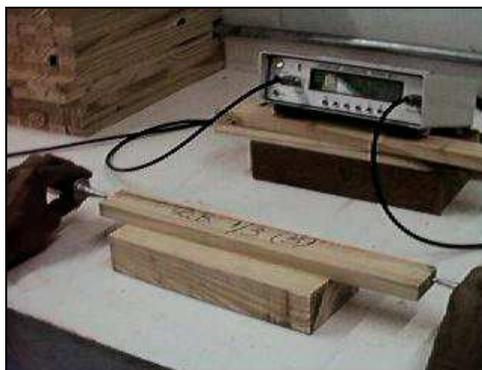
Figura 3.15. Aplicação do ultra-som no corpo-de-prova
