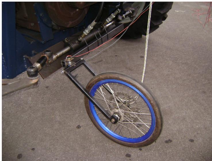
Figura 31: Montagem da quinta roda com sensor de rotação. Fonte: Dados da pesquisa.
