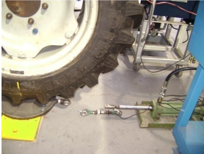
Figura 116: Posição do atuador hidráulico, localizado à frente da roda dinamométrica com o objetivo de simular força longitudinal na roda dinamométrica. Fonte: Dados da pesquisa.
