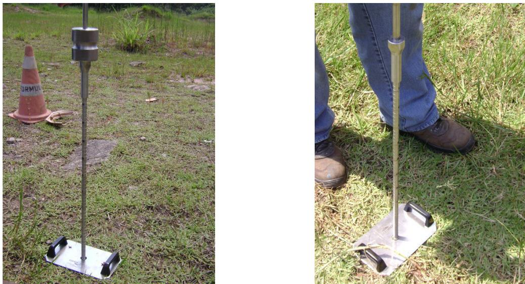
Figura 56: Medição de índice de cone com auxílio de um penetrômetro. Fonte: Dados da pesquisa.
