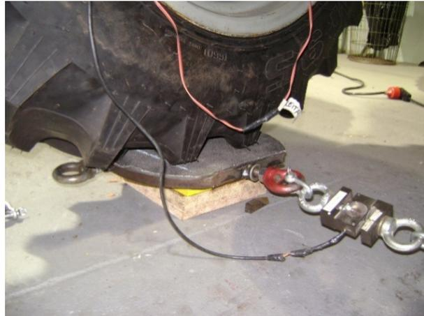
Figura 46: Sistema anti- atrito e apoio da roda dinamométrica. Fonte: Dados da pesquisa.
