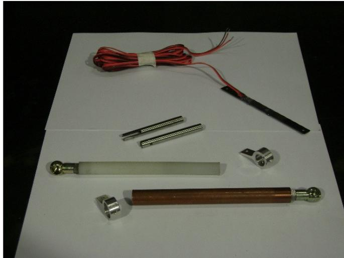
Figura 35: Componentes que formam a construção do sensor de deslocamento. Fonte: Dados da pesquisa.
