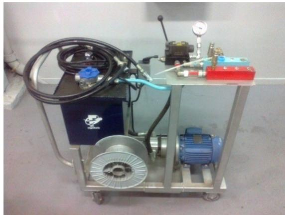
Figura 24: Bancada de acionamento hidráulica. Fonte: Dados da pesquisa.
