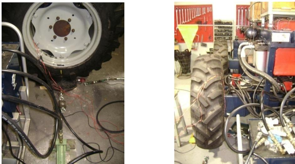
Figura 45: Roda dinâmométrica apoiada sobre a plataforma e devidamente conectada ao sistema de aquisição de dados. Fonte: Dados da pesquisa.
