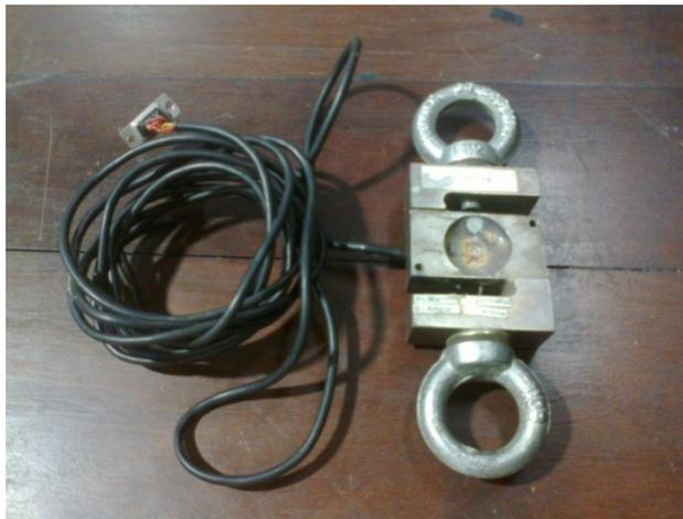
Figura 28: Célula de carga para leitura da força aplicada à roda dinamométrica com fundo de escala de 12500N. Fonte: Dados da pesquisa.
