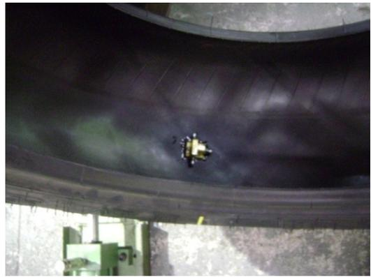
Figura 40: Marca indicadora da posição de montagem dos sensores e a sapata de fixação dos sensores de deslocamento linear no pneu. Fonte: Dados da pesquisa.
