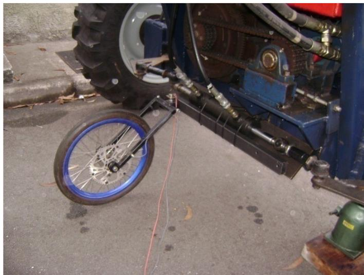
Figura 54: Fixação da quinta roda ao chassi do veículo. Fonte: Dados da pesquisa.
