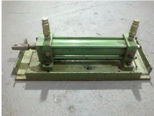
Figura 27: Atuador hidráulico utilizado na calibração da roda dinamométrica. Fonte: Dados da pesquisa.
