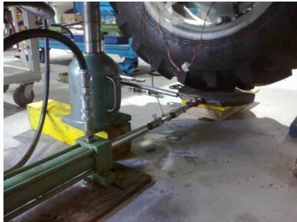
Figura 47: Ilustração geral do ensaio de calibração da roda dinamométrica. Fonte: Dados da pesquisa.
