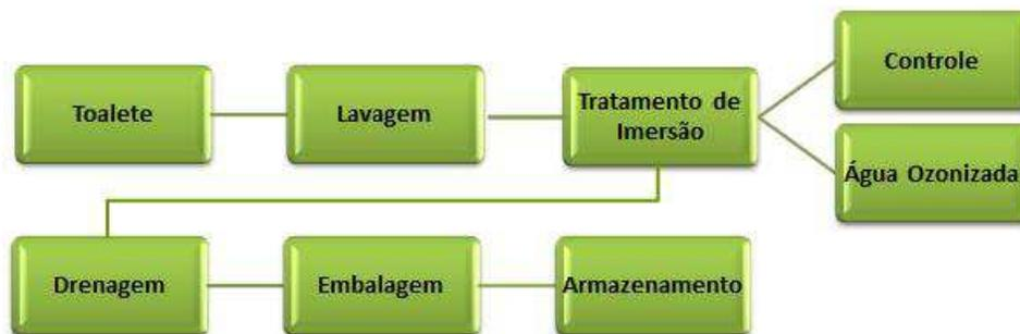
**Figura 3.** Fluxograma geral do processo.
