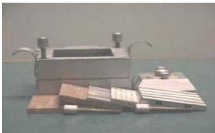
*Figura 2: Caixa de corte utilizada no ensaio de cisalhamento*
