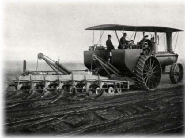
Figura 3. O motor a vapor iniciou o processo de mecanização da agricultura, a figura mostra uma máquina a vapor tracionando um arado de 7 aivecas.
