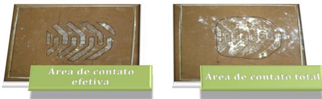
Figura 34. Determinação da área de contato pneu-solo, a área do retângulo é de  $0,39 \text{ m}^2$ .
