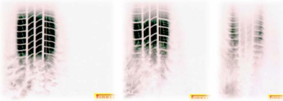
Figura 8. Imagens que mostram a área de contato do pneu em piso molhado em três velocidades, 30, 70 e 100  $\text{km}\cdot\text{h}^{-1}$ , da esquerda para a direita.
