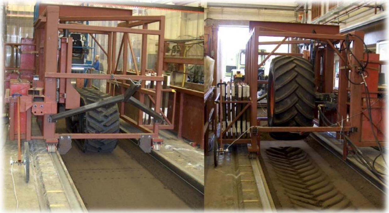
Figura 24. Caixa de solos da Universidade de Cranfield, ensaios com esteira (esquerda) e pneu (direita).
