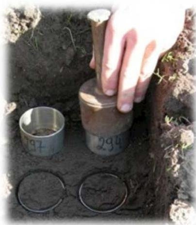
Figura 33. Anéis amostradores de densidade.
