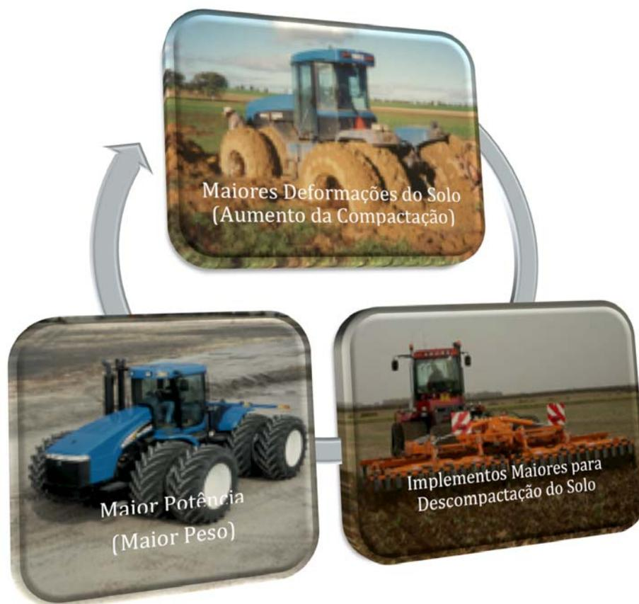
Figura 12. Esquema do ciclo formado pela compactação do solo e a necessidade do aumento da potência para cultivo.
