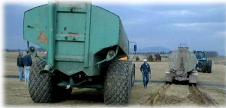
Figura 13. Deformação do solo provocada por pneus de alta flutuação (esquerda) e pneus convencionais (direita).
