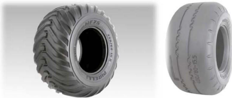
Figura 26. Modelos de pneus ensaiados, Pirelli HF-75 (CG) e Pirelli RA-28 (SG).
