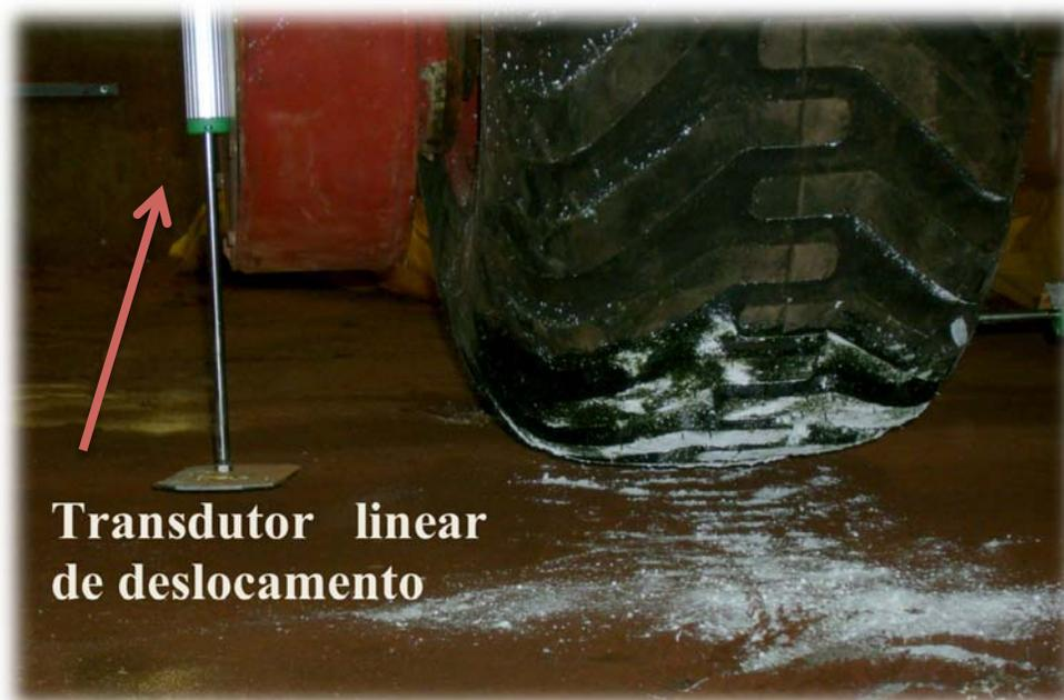
Figura 30. Dispositivos para determinar a deformação total e lateral do pneu.
