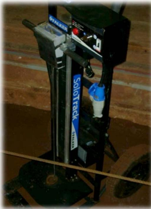
Figura 32. Penetrômetro automático SOLOTRACK da FALKER.
