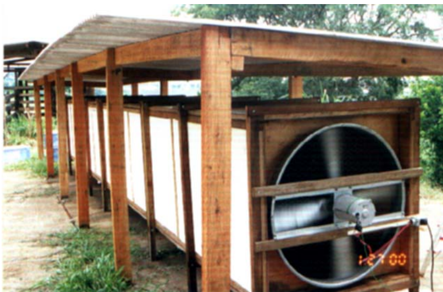
Figura 8: Vista externa do túnel e do ventilador tipo tufão.
