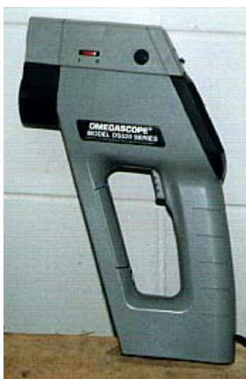
Figura 5: Vista do termômetro de raio infravermelho, com mira a laser.
