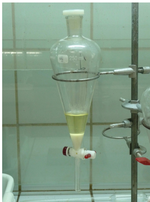
Figura 12. Funil de separação contendo as fases éster e fase glicerol e catalisador depositados no fundo
