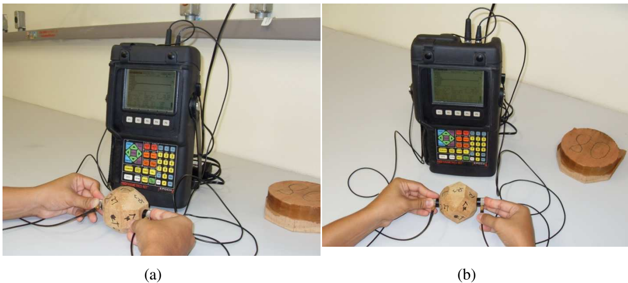
Figura 3.9. Ensaio de ultrassom no poliedro na direção radial (a) e a 45° no plano RL (b)
