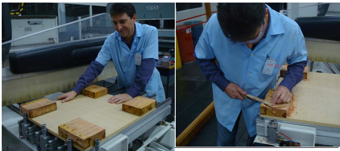
Figura 3.4. Montagem dos corpos de prova para entrada no CNC (a) e verificação dos
