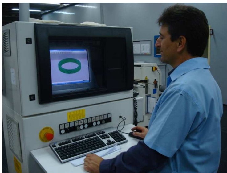
Figura 3.3. Disco multifacetado sendo confeccionado em máquina CNC (SENAI de Itatiba).
