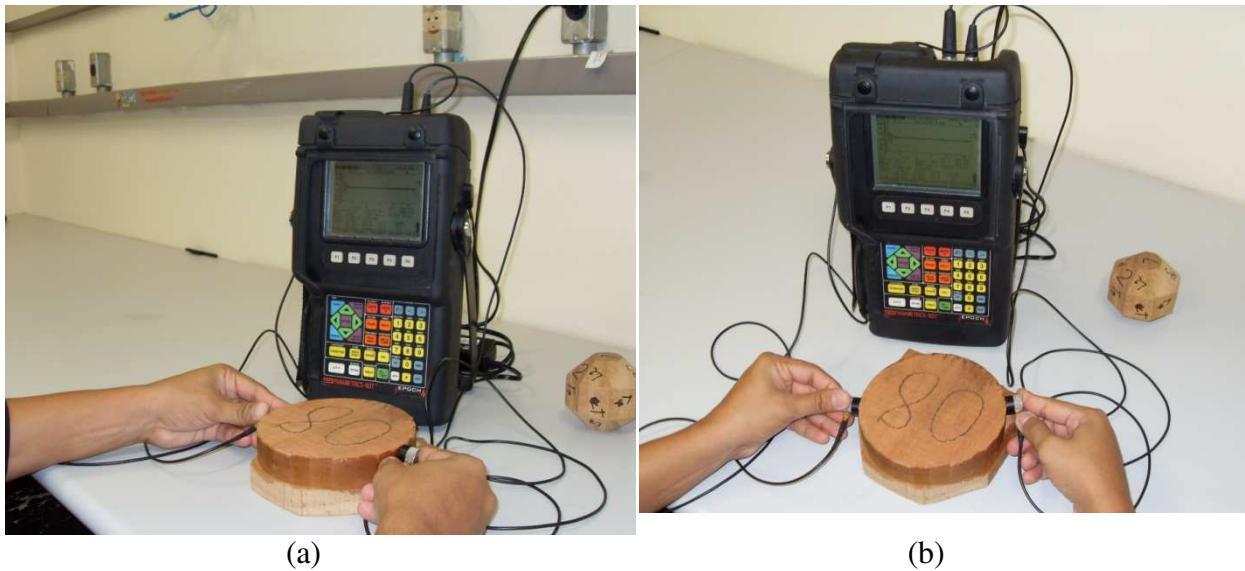
Figura 3.8. Ensaio de ultrassom, no disco multifacetado na direção radial (a) e a 45^{\circ} no plano RL(b)
