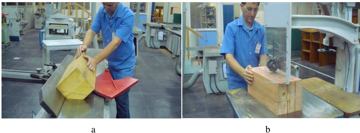
Figura 3.1. Prismas de garapeira (a) e de Eucalipto saligna (b) durante a confecção dos corpos de prova
