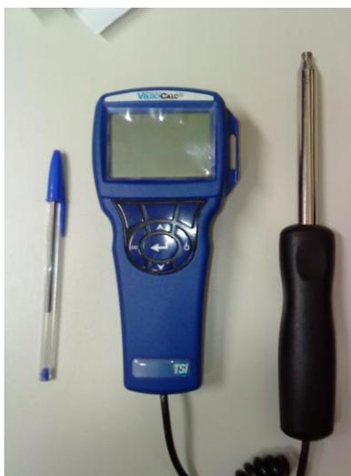
Figura 13: Anemômetro de fio quente.
