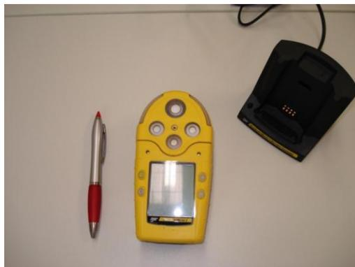
Figura 15: Medidor de Gases  $\text{NH}_3$  e  $\text{CO}_2$ .
