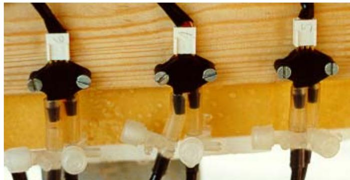
Figura 4.5. Foto ilustrando transdutores de pressão
