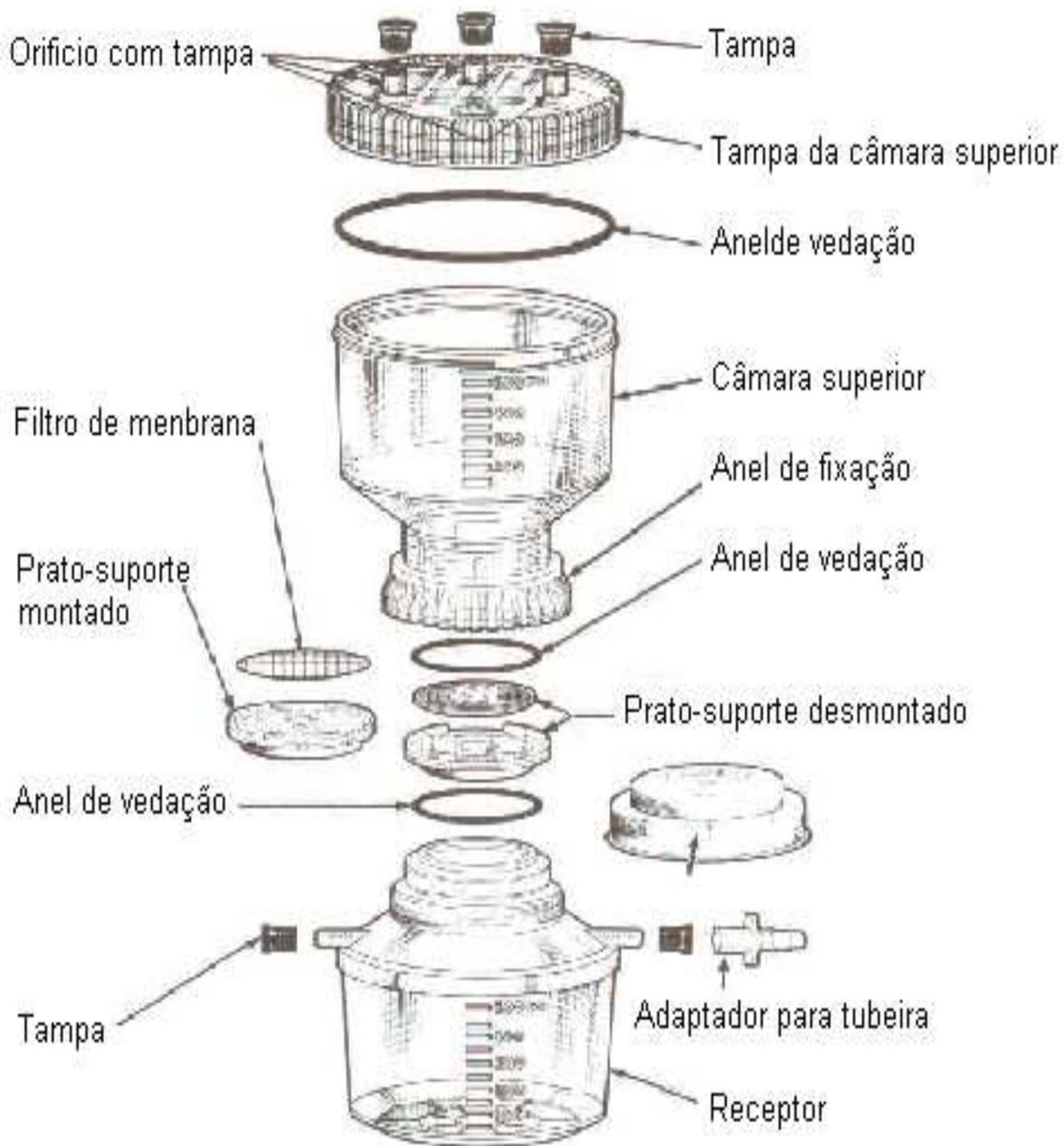
Figura 4.6. Suporte de filtro com receptor da marca NALGE COMPANY usado para determinação de sólidos suspensos totais.
