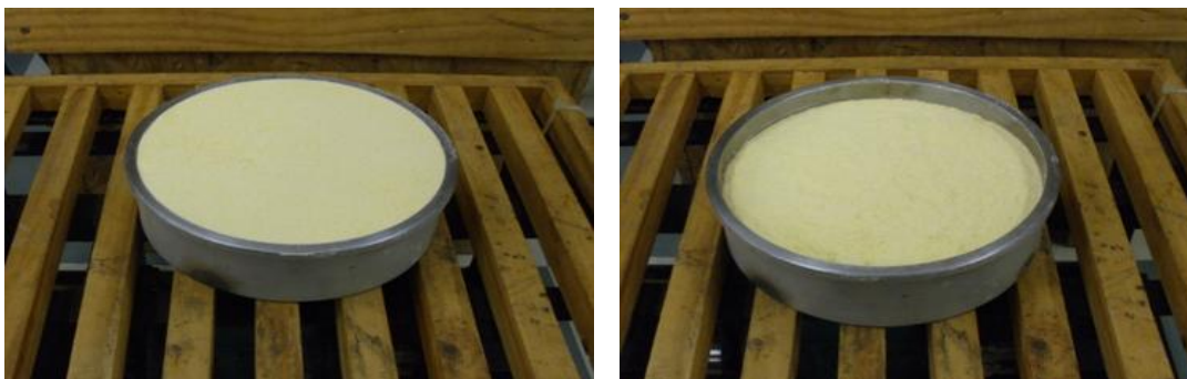
Figura 39 – Ilustração da acomodação do fubá de milho moído antes e após a vibração.
