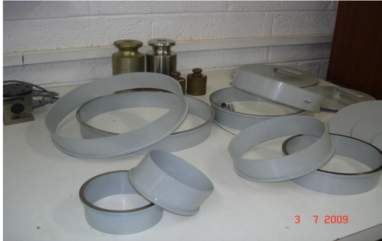
Figura 29 – Células circulares de 100, 150, 200 e 250 mm, utilizadas nos ensaios de cisalhamento.
