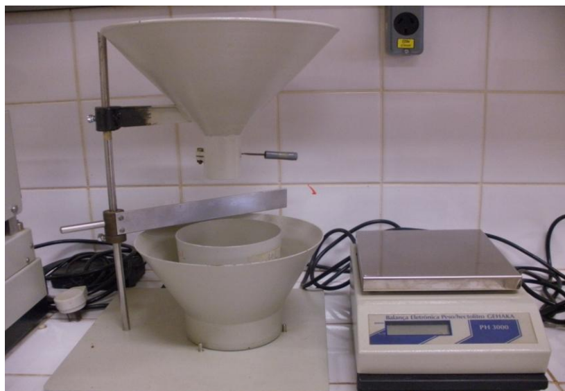
Figura 25 – Conjunto para determinação do peso específico aparente.
