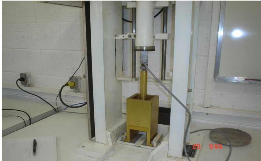
Figura 33 – Aparato utilizado no ensaio de relaxação dos grãos de mamona. (Laboratório de propriedades mecânicas – FEAGRI/Unicamp).
