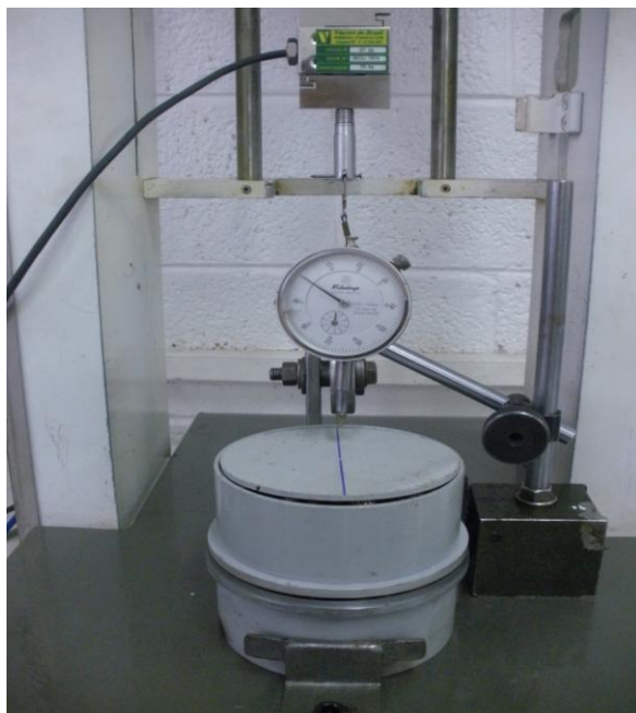
Figura 37 – Ilustração da posição inclinada da tampa após ensaio de cisalhamento em grãos de mamona.
