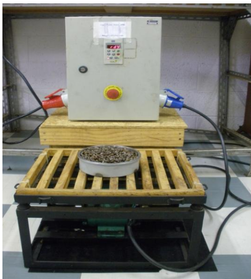
Figura 38 – Mesa vibratória utilizada para promover compactação dos produtos. (Fonte: Laboratório de propriedades mecânicas – FEAGRI/Unicamp)
