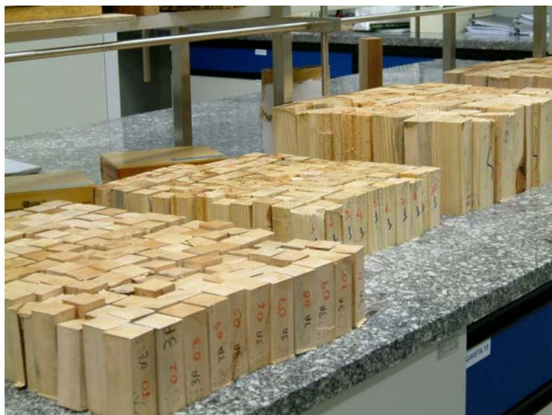
Figura (4.2) - Corpos-de-prova de Pinus e Eucalypto para avaliação visual depois do ensaio de compressão paralela às fibra.
