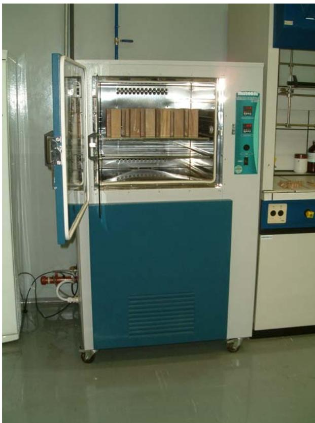
Figura (4.1) - Câmara climática, com controle de temperatura e umidade (Laboratório de Ensaios do SENAI de Itatiba).
