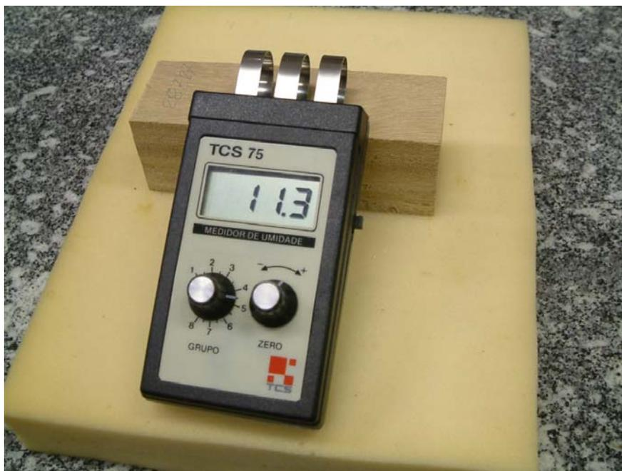
Figura (4.6) - Medidor de umidade superficial de três pólos; marca TCS modelo 75 E.
