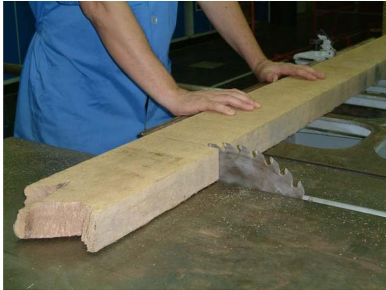
Figura (4.8) - Ilustração do corte de um terço para composição do corpo-de-prova
