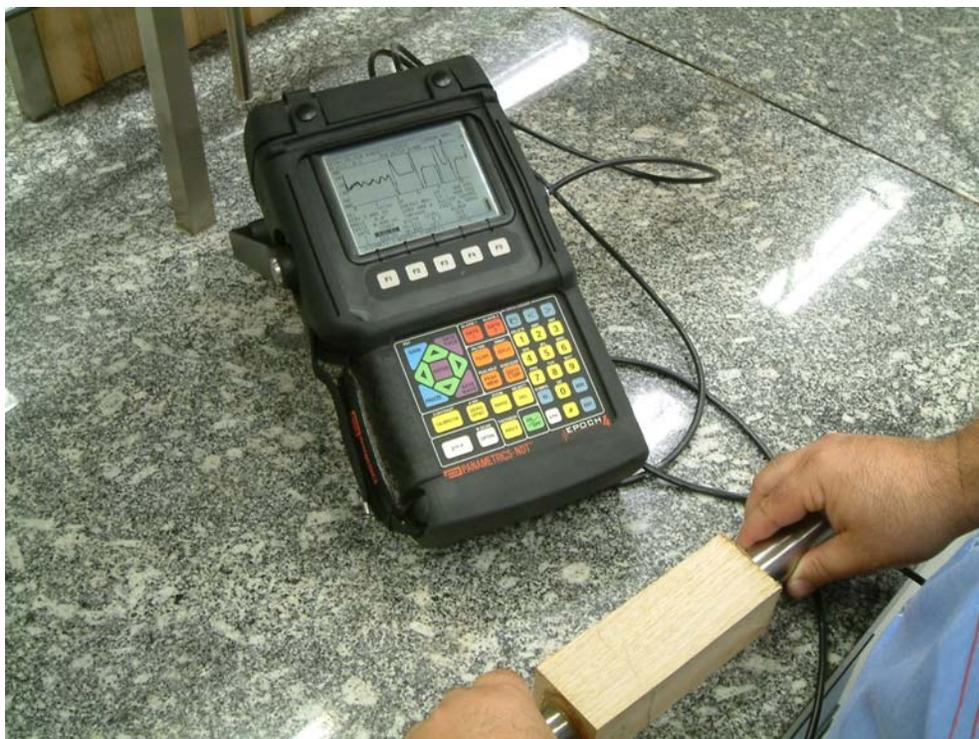
Figura (4.5) - Equipamento EPOCH da Panametrics-NDT acoplado a transdutor de face plana e frequência de 100 kHz - Laboratório de Ensaio de Materiais da Faculdade de Engenharia Agrícola da UNICAMP
