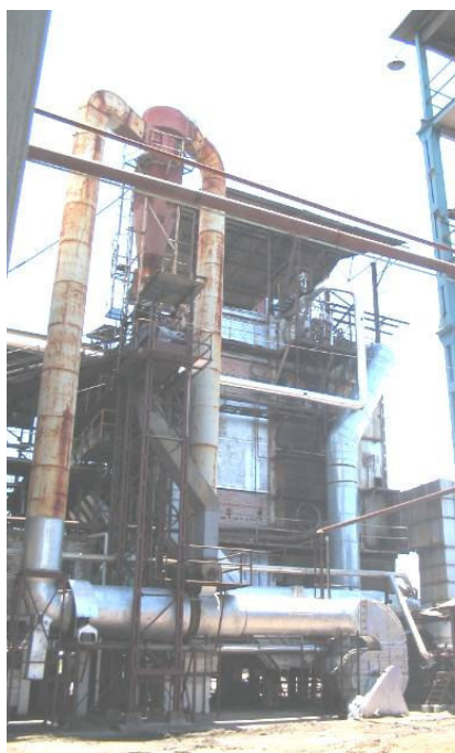
Figura 4 - Secador flash em escala industrial instalado em Nunorco, Tucumam Argentina. Fonte: SOSA-ARNAO et al. ( 2004)
