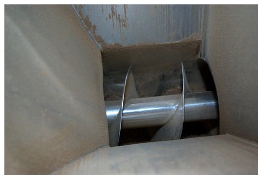
Figura 24 - Alimentador tipo parafuso
