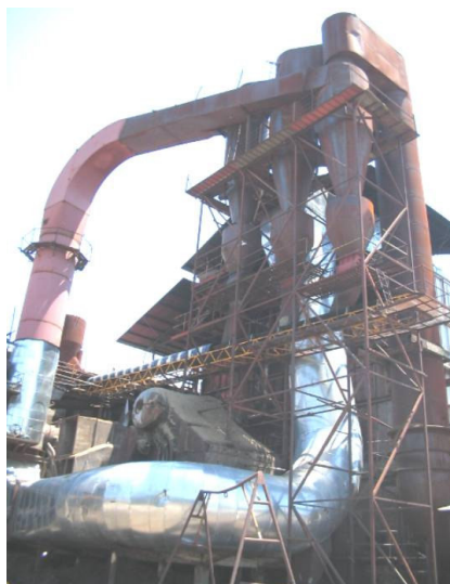
Figura 5 - Secador flash em escala industrial instalado em Leales, Tucumam Argentina.
