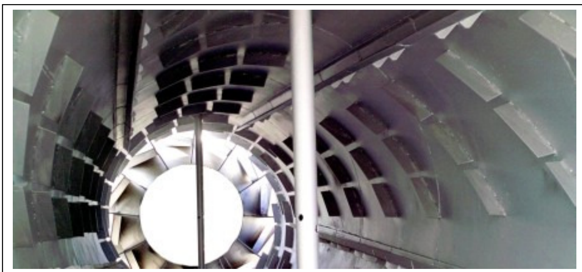
Figura 7 - Detalhes das aletas no interior do secador rotativo.
