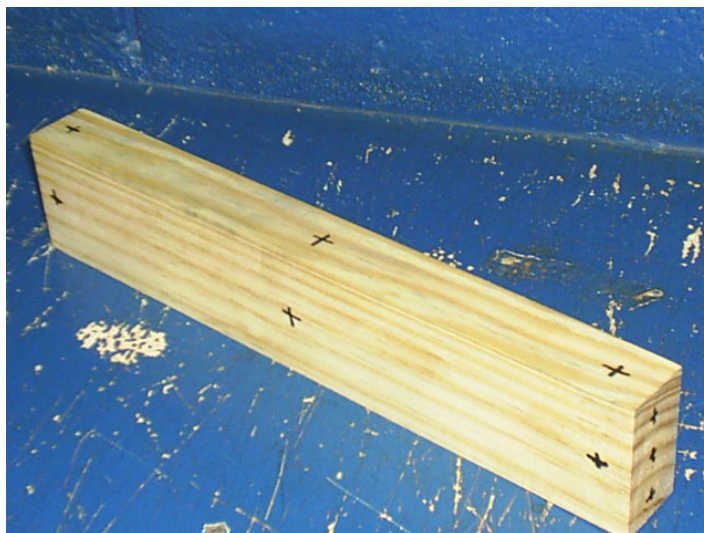
Figura 3.3 – corpo de prova demarcado nas três faces para as medições de tempo de propagação da onda de ultra-som
