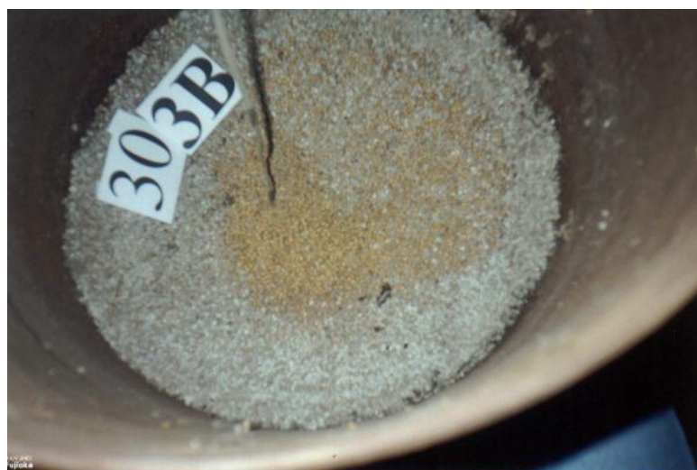
Figura 19. Deterioração por fungos, camada intermediária, sentido radial
