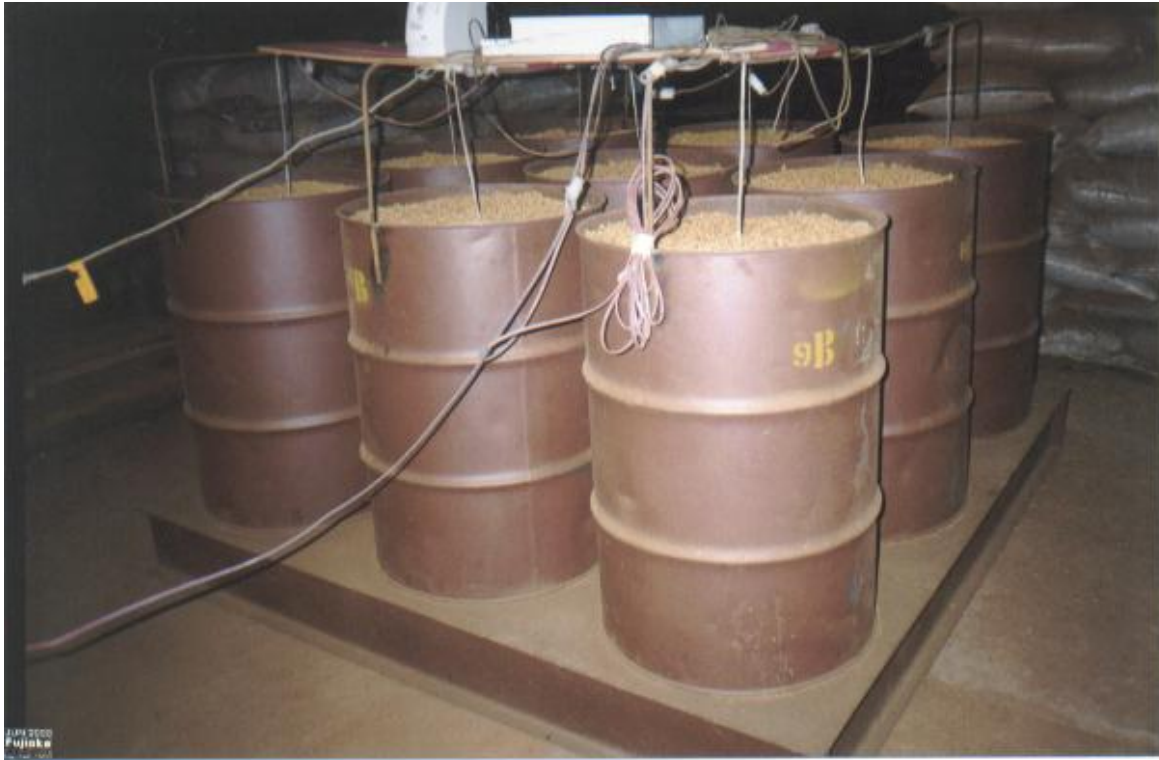
Figura 5. Vista dos silos de armazenagem sem sistema de aeração
