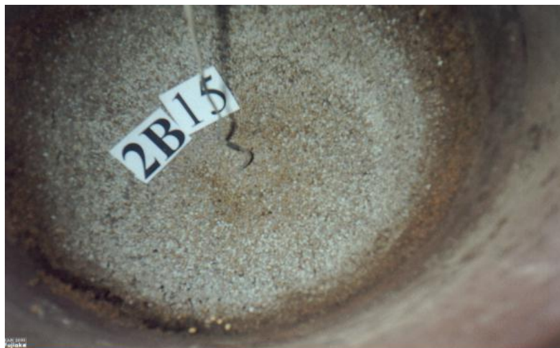
Figura 29. Deterioração ocorrida devido à presença de fungos no silo 2B, sem sistema de aeração, na profundidade de 15cm em relação ao piso
