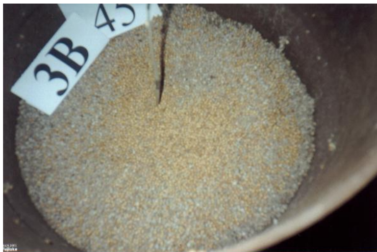
Figura 18. Início da deterioração por fungos na camada superior, sentido radial
