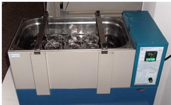
Figura 3.2 - Equipamento de desidratação osmótica.
