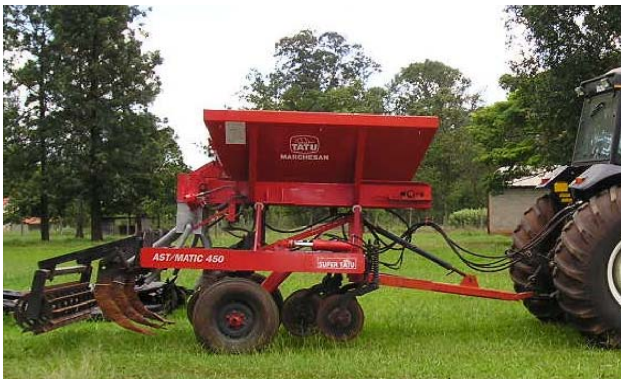
FIGURA 02 - Protótipo de máquina agrícola composto por um escarificador e um distribuidor de fertilizantes conjugados.
