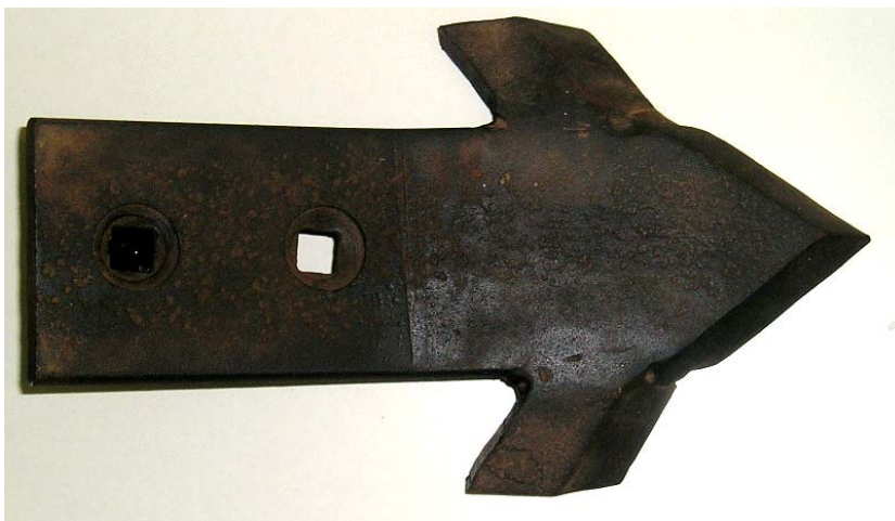
FIGURA 04 - Ponteira alada desenvolvida por SANTOS (1994).
