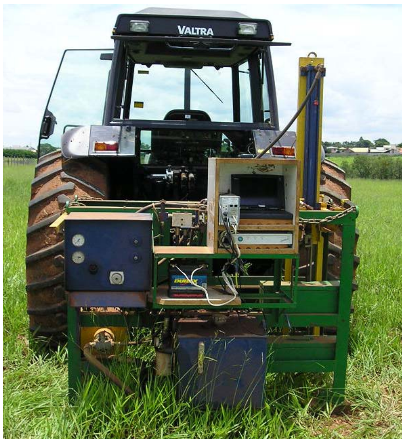
FIGURA 05 - Penetrógrafo hidráulico eletrônico desenvolvido por LINS E SILVA et al. (1995).
