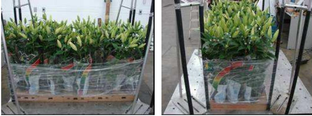
Figura 7.a) e b) Disposição das caixas com os vasos no estádio botões na mesa vibratória.
