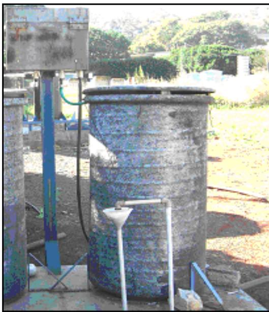
**Figura 5:** Filtro lento utilizados como ponto de coleta das amostras nos tratamentos dos reatores de fotocatalise, SODIS e Aerado.
