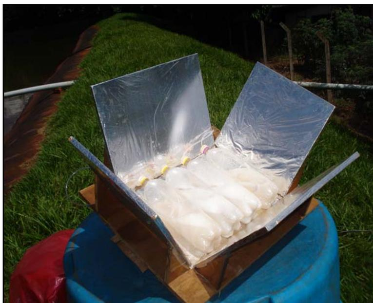
**Figura 6:** Sistema de Fotocatálise Heterogênea solar em garrafas PET.
