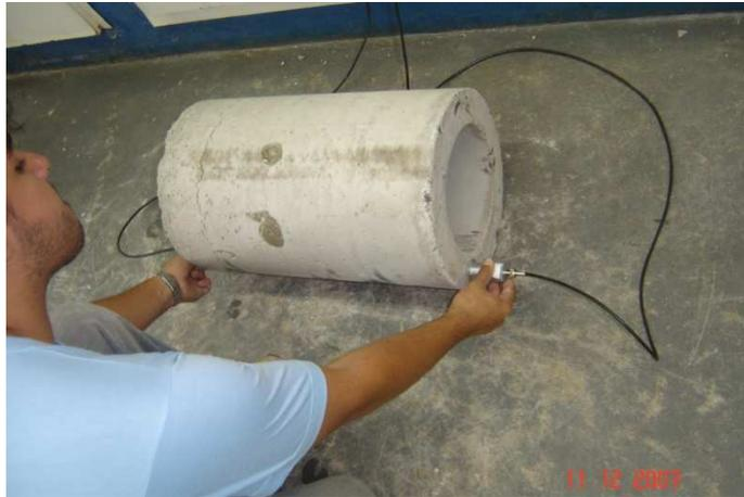
**FIGURA 3.5.** Ensaio de ultra-som nos protótipos – condição direta na direção longitudinal
