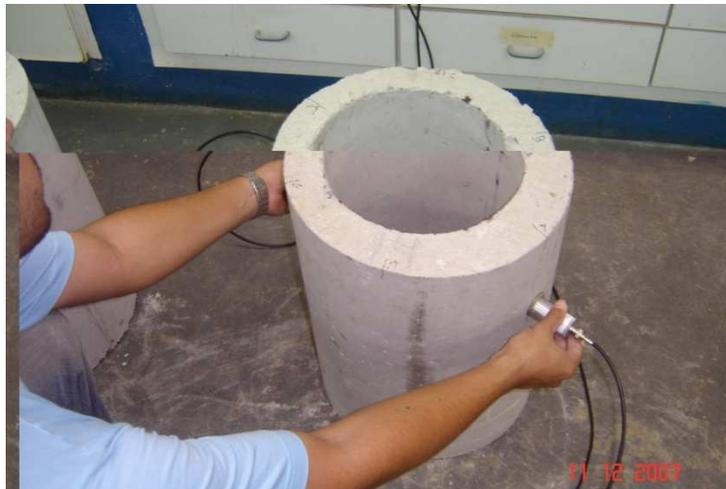
**FIGURA 3.6.** Ensaio de ultra-som nos protótipos – condição direta na direção radial
