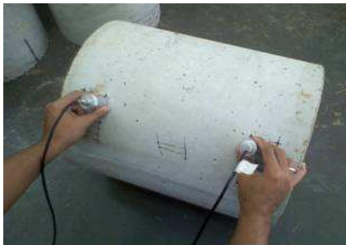
**FIGURA 3.7.** Ensaio de ultra-som nos protótipos – condição indireta ou superficial
