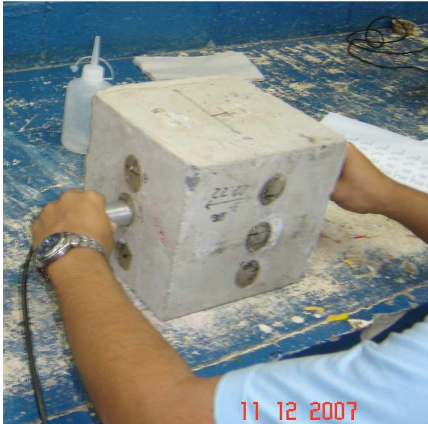
**FIGURA 3.9** – Ensaio de ultra-som nos corpos-de-prova prismáticos
