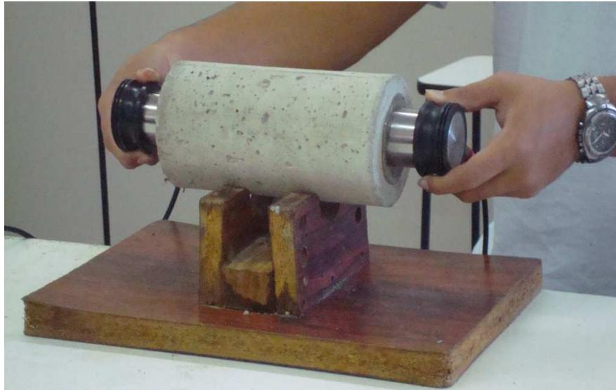
**FIGURA 3.8** – Ensaio de ultra-som nos corpos-de-prova cilíndricos
