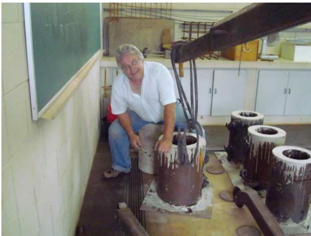
**FIGURA 3.3 a** – formas após a concretagem
