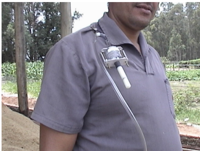
Figura 18. Detalhe do uso de bomba de amostragem pessoal para avaliação da fração respirável.
