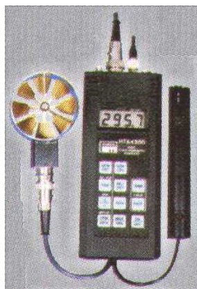
Figura 14. Vista do HygroThermoAnemometer (Modelo HTA 4200, Marca Pacer®, USA).
