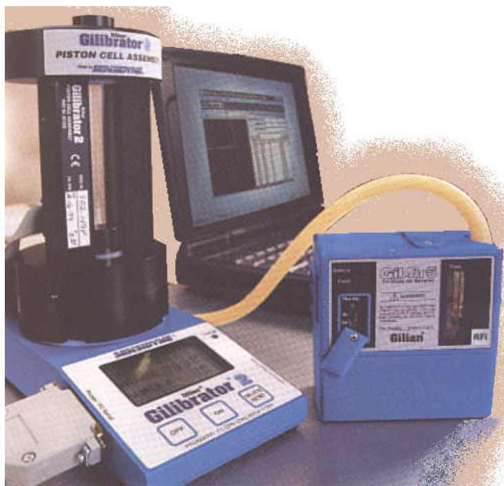
Figura 94. Calibração da bomba de amostragem pessoal com o Calibrador Gilibrator, Gilian, USA.
