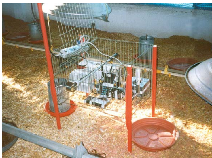
Figura 15. Vista da gaiola metálica confeccionada para acondicionar os equipamentos em cada setor de cada galpão, a 50cm de altura do piso.
