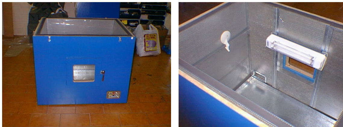
Figura 29. Vista da câmara semi-anecóica para avaliação da vocalização de pintainhos.
