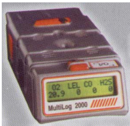
Figura 23. Multilog 2000 (Quest®, USA) para avaliação contínua da concentração dos gases CO, CH_4 , NH_3 e NO no ar.
