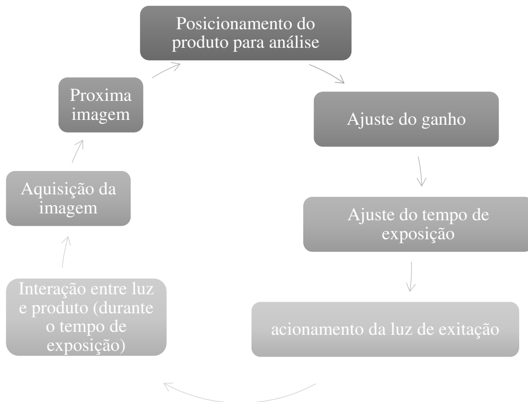
Figura 10. Fluxograma do método de aquisição das imagens espectrais.
