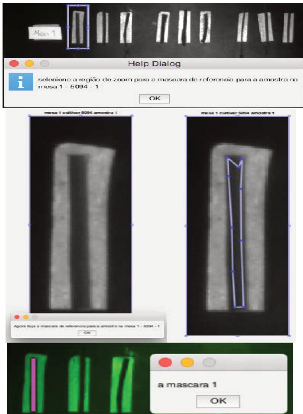
Figura 30. Passos do processo de criação da máscara binária para segmentação usando a interface da ferramenta computacional criada.
