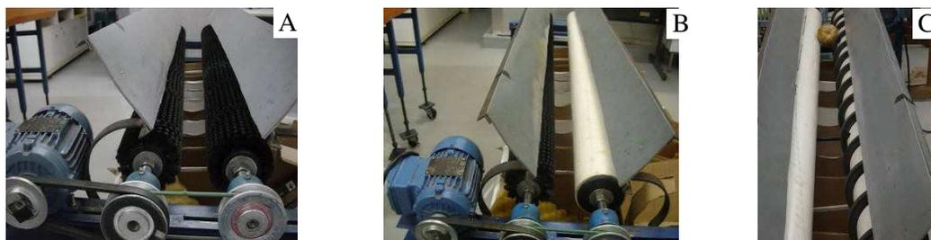
Figura 4: Conjuntos de cilindros avaliados. A) Dois cilindros com cerdas - CC; B) Um cilindro com cerdas e um liso - CL; C) Um cilindro liso e outro com helicóide - LH.
