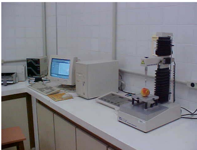
Figura 08. Medição da firmeza dos pêssegos pelo texturômetro.
