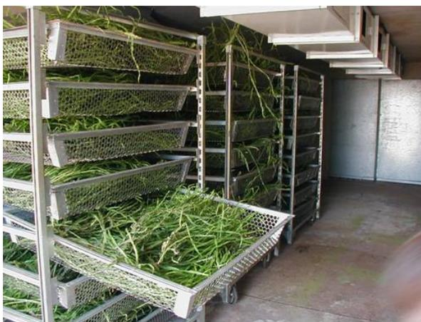
Figura 16 - Detalhe interno do secador a gás, disposição das bandejas de secagem ao longo do processo.
