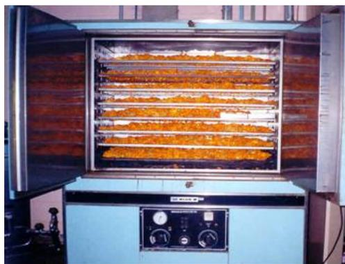
Figura 9 – Estufa com circulação forçada de ar.
