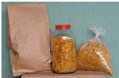
Figura 13 - Embalagens protetoras: papel kraft, vidro e polietileno de baixa densidade, vista da esquerda para direita na figura.
