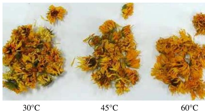
Figura 36 - Amostras da droga vegetal seca em secador a gás, da esquerda para direita, temos as comparações de temperaturas, 30, 45 e 60°C.
