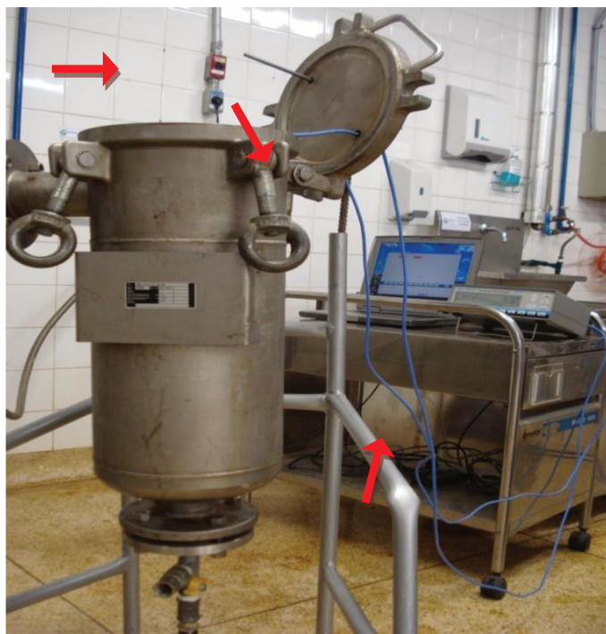
Figura 11. Aparato experimental utilizado nos ensaios com vapor e sua instrumentação com termopares indicadas pelas setas em vermelho.
