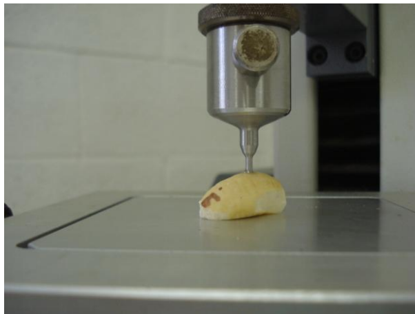
Figura 9. Ensaio de penetração com ponteira cilíndrica de uma amêndoa.
