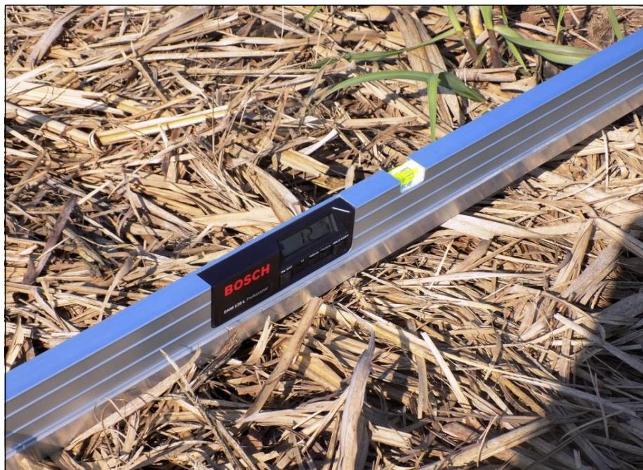
**Figura 10.** Medição digital da declividade do terreno com o aparelho DNM 120L Professional.
