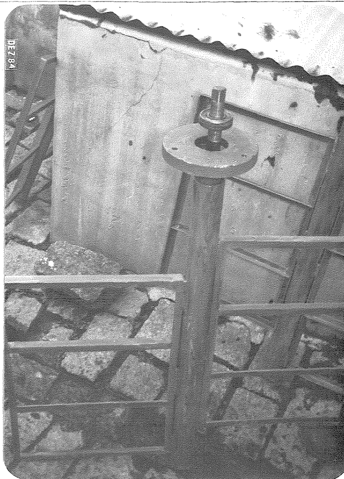
FIGURA 4.8. Detalhe do rolamento no agitador
