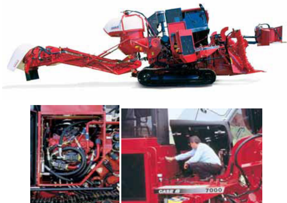
Figura 12 – Sistema de tombamento da cabine para acesso aos componentes hidráulicos e mecânicos da colhedora CASE série 7700.
