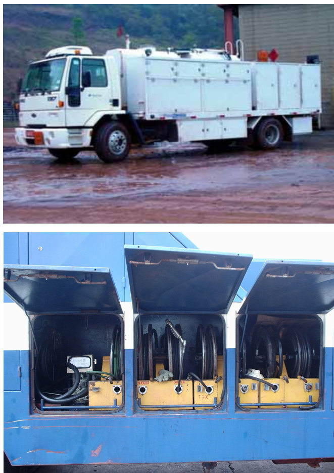
Figura 7 – Comboio de abastecimento e detalhe do sistema de abastecimento em campo.
