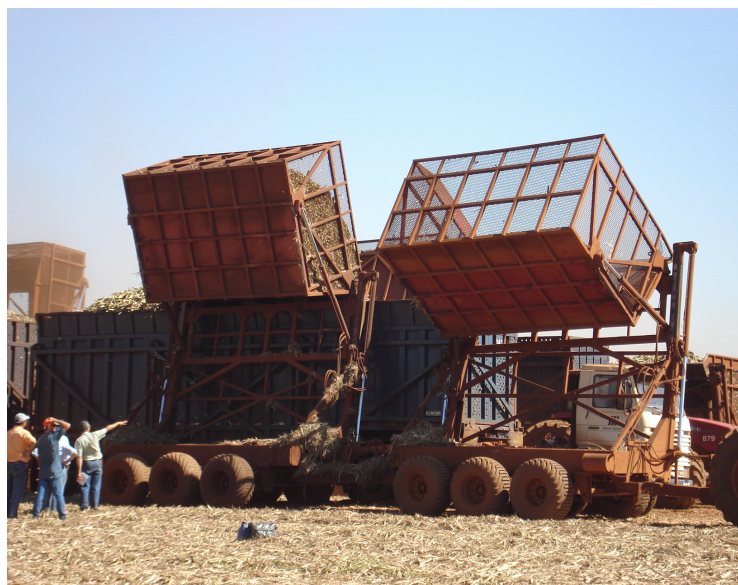
Figura 10 – Transbordo efetuado em espaço reservado para manobras de veículos.
