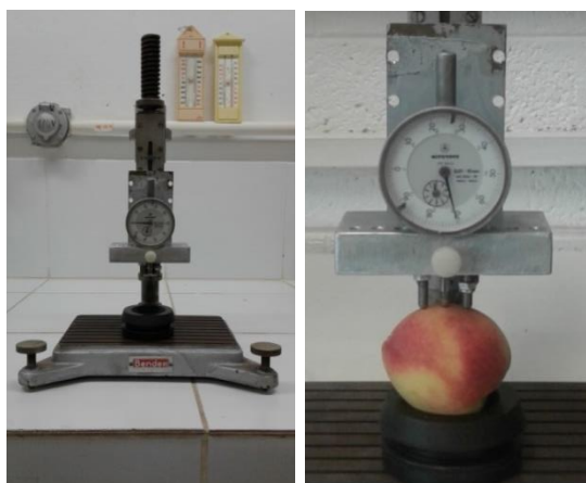
Figura 15. Dispositivo para medir deformação (esquerda) e detalhe com fruto (direita).
