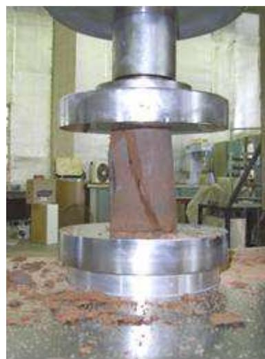
**Figura 24.** Ensaio de compressão simples aplicado aos corpos-de-prova.
