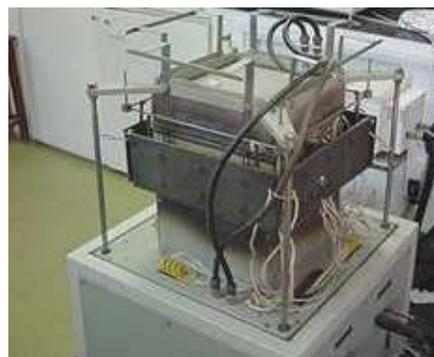
**Figura 42.** Equipamento para ensaio de condutividade.
