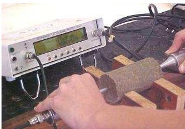
**Figura 23.** Ensaio de ultra-som aplicado aos corpos-de-prova.
