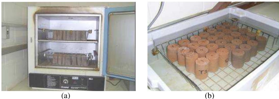
**Figura 25.** Procedimentos para os ensaios de absorção de água e durabilidade: (a) secagem dos corpos-de-prova e (b) molhamento dos corpos-de-prova.
