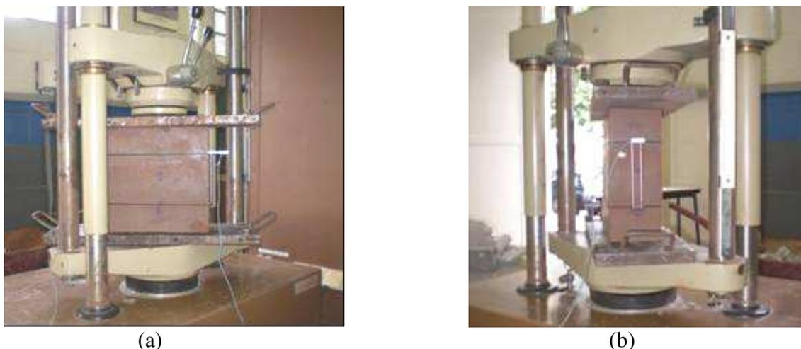
**Figura 37.** Ensaio de compressão simples dos mini-painéis e localização dos extensômetros.
