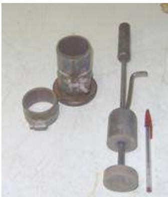
**Figura 13.** Molde cilíndrico e compactador
