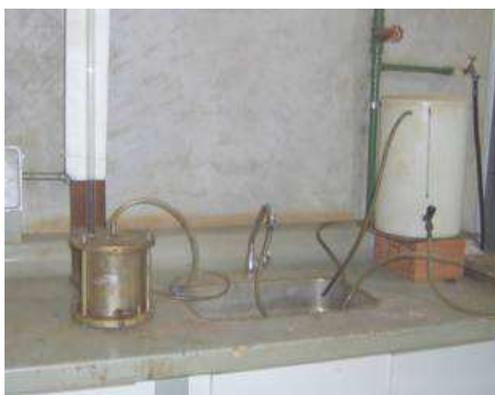
**Figura 19.** Permeômetro com carga variável.
