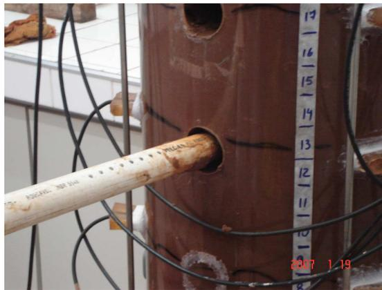
Figura 13: Aberturas na parede da coluna e tubo de PVC utilizados na amostragem de solo nos diferentes pontos de monitoramento.
