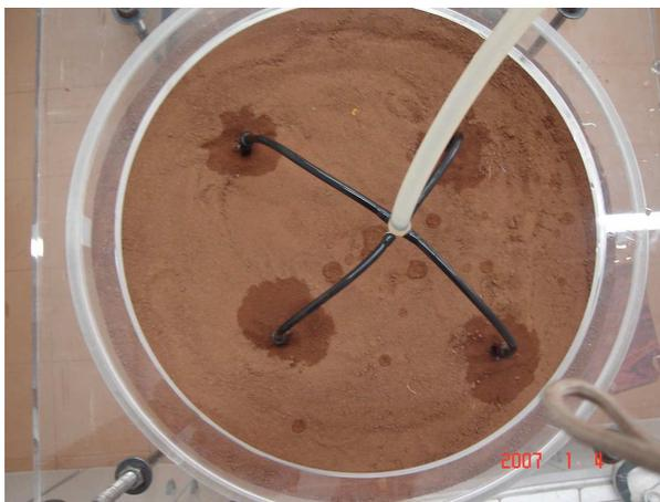
Figura 11: Gotejadores utilizados na aplicação da solução à coluna
