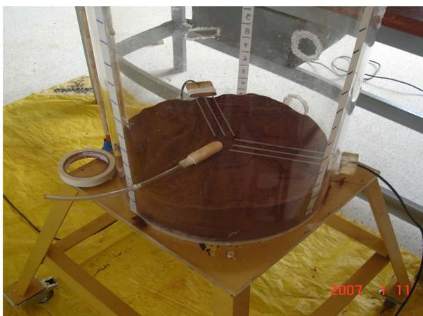
Figura 9: Preenchimento da coluna de solos e instalação dos extratores e das sondas de TDR.
