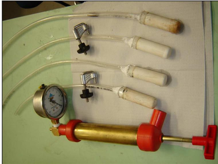
Figura 2: Extratores e bomba manual de vácuo utilizados na extração de solução das colunas de solo.
