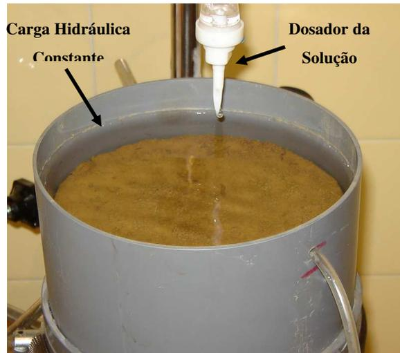
Figura 2: Coluna de solo com carga constante de água com aplicação simultânea da solução
