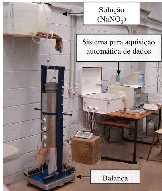
Figura 3: Aparato experimental utilizado nos ensaios com coluna deformada e indeformada.
