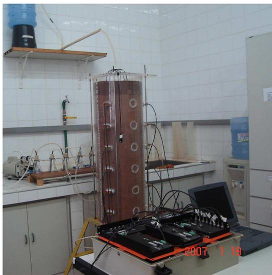
Figura 10. Coluna de solo equipada com sondas de TDR, extratores de solução e sistema automatizado para aquisição de dados.
