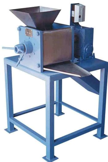
**Figura 4.2 – Mini-prensa MPE – 40 ECIRTEC para extração de óleo**
