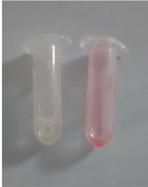
**Figura 9.** Mudança de coloração da amostra com a adição de 0,2 % de HCl concentrado.
