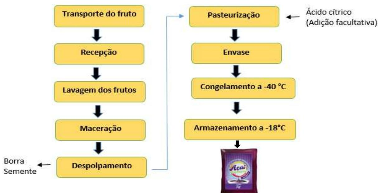
**Figura 1:** Fluxograma geral do processamento (industrial) do fruto do açaizeiro para obtenção de açaí do tipo A, B ou C congelado.
