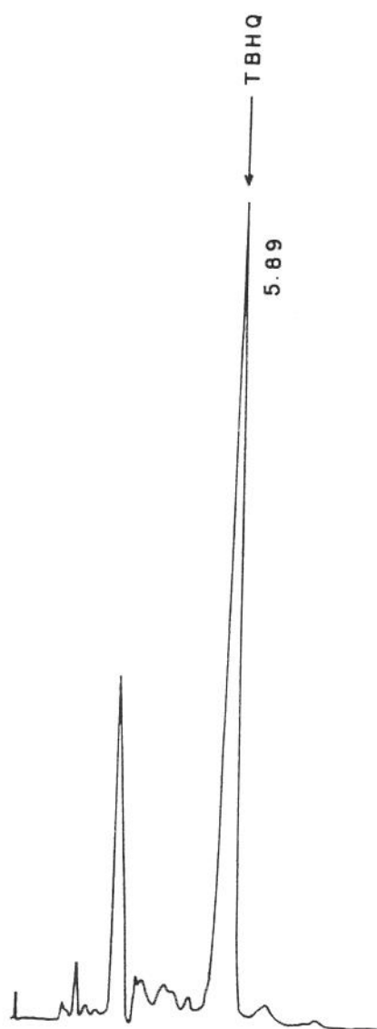
Anexo 9 - Cromatograma por CLAE de uma amostra de óleo de soja (marca A) – indicativo da confirmação do pico. Condições de análise: fase móvel (III) acetonitrila:água:metanol (36:60:4, v/v); fluxo 1 ml/min., coluna C 18 Vydac 201 – TP 54 (25 cm X 4,6 mm d.i., partículas de 5 µm), detector UV (280 nm). TBHQ: terc -butil hidroquinona.
