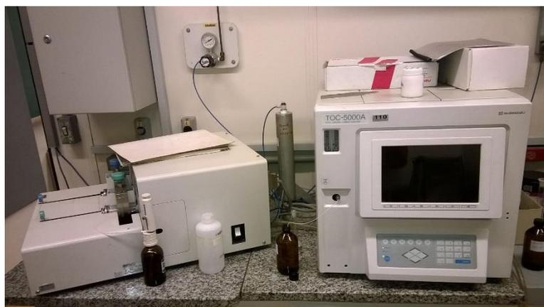
Figura 16 - Equipamento para determinação do COT.
