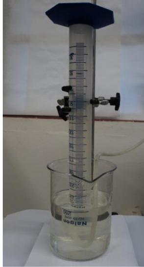
Figura 21 - Sistema para medição do volume do biogás gerado.
