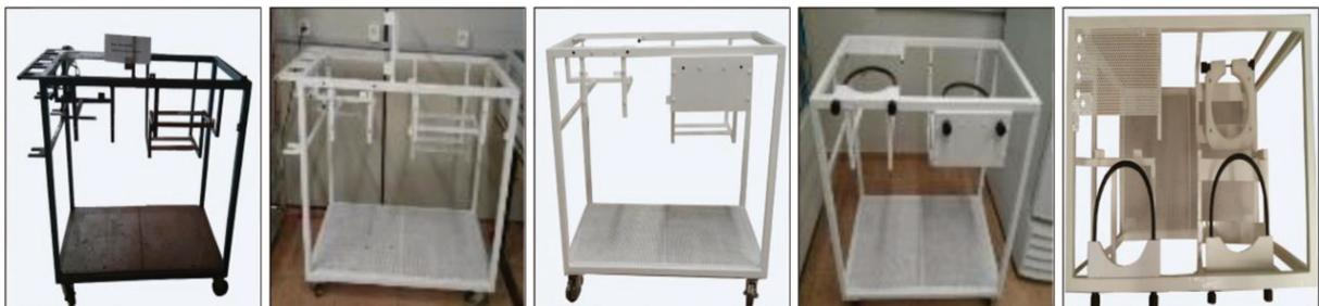
Figura 6 - Ilustração da estrutura para acomodação do sistema de digestão anaeróbia.
