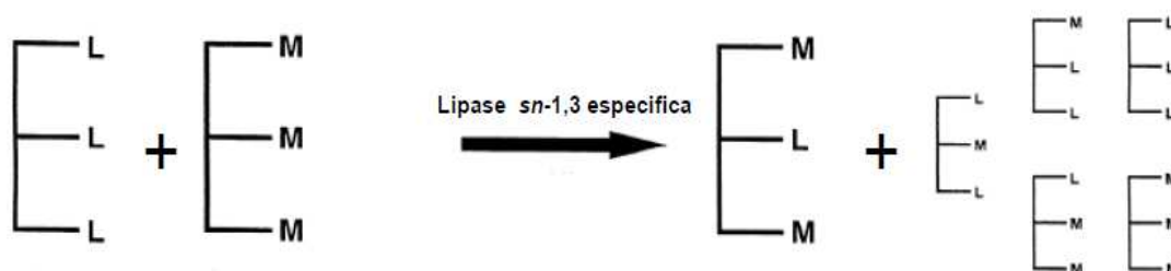
Figura 2. Mecanismo de reação de interesterificação enzimática usando a lipase específica sn-1,3 (IWASAKI; YAMANE, 2000).
