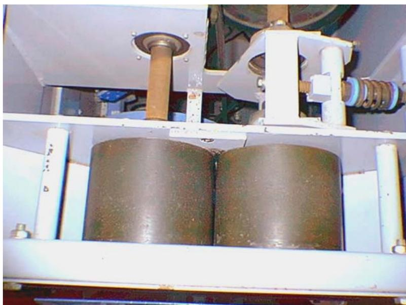
Figura 10. Vista superior dos cilindros de borracha e da mola de pressão.
