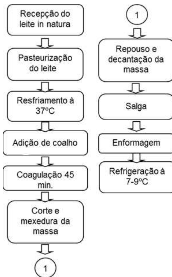
Figura 1 - Etapas de processamento do queijo Minas frescal (adaptado de SANTOS e HOFFMAN, 2010).
