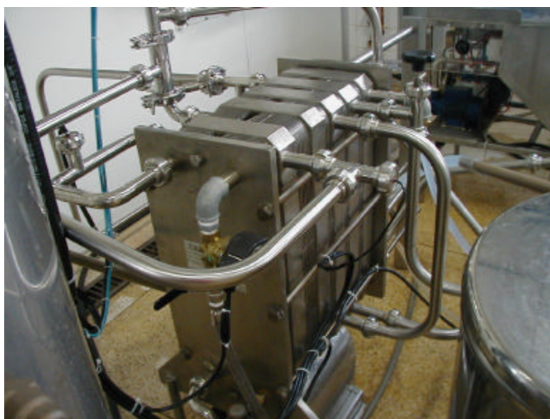
FIGURA 5. Trocador de calor a placas utilizado na presente pesquisa (planta piloto de processamento e acondicionamento asséptico de alimentos líquidos em garrafas plásticas - Faculdade de Engenharia de Alimentos – UNICAMP, Campinas, SP).
