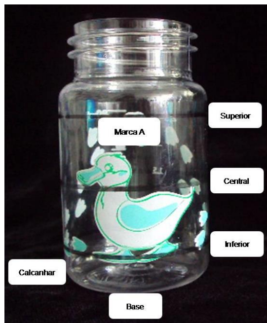
Figura 1: Pontos de determinação de espessura nas mamadeiras analisadas
