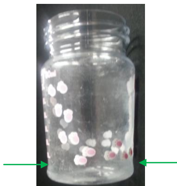
Figura 3: Mamadeira da marca A após o processo de fervura em água.
