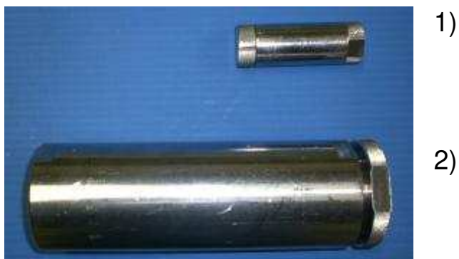
Figura 4.2 – 1: Célula de extração identificada como 5mL; 2: Célula de extração identificada como 300mL.
