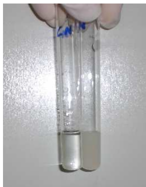
Figura 9.6 – 4º experimento: Soluções de reação sem a adição de substrato. (CN= \text{DH}_2\text{O} +EtOH; N= \text{DH}_2\text{O} +Extrato)
