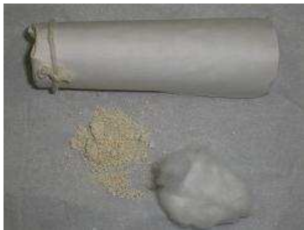
Figura 5.3 – Amostra PQ após extração exaustiva em aparelho sohxlet por 12 horas com éter de petróleo como solvente.
