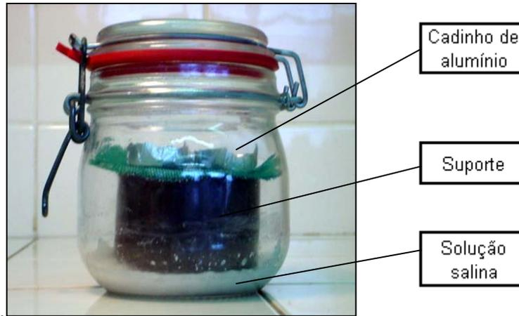
**Figura 3.3:** Detalhes do pote com fechamento hermético.
