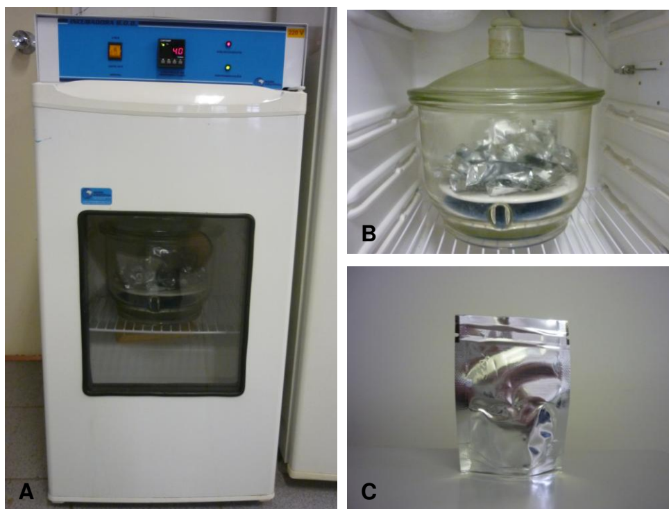
Figura 5. Armazenamento das micropartículas probióticas. A: Estufa; B: Dessecador com sílica gel; C: Embalagem de poliéster metalizado e polietileno selada a vácuo.
