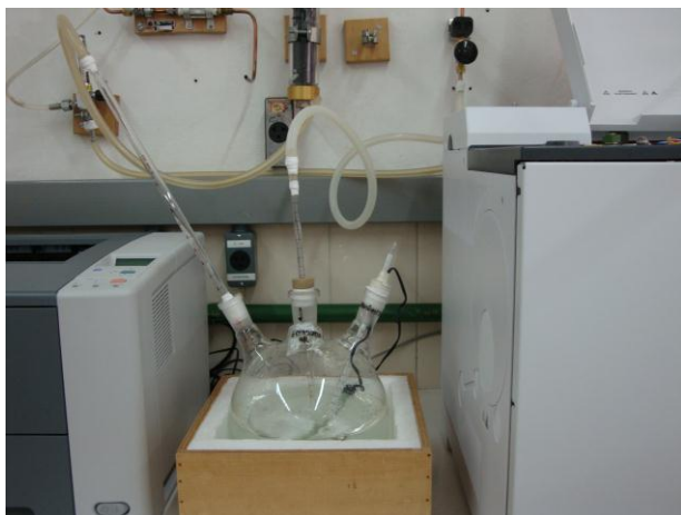
Figura 8: Sistema de purificação e umidificação do ar utilizado na avaliação CG-olfatométrica dos efluentes cromatográficos.
