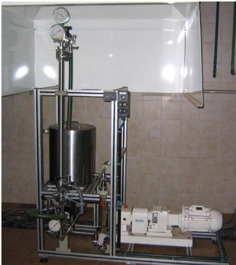
**Figura 7.** Foto da unidade de Ultrafiltração.
