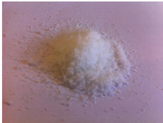
Figura 24: Produto seco obtido em VSD com solução de alimentação a 40 °Brix.
