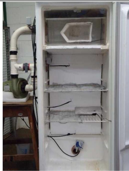
Figura A 14. Parte frontal da bomba de calor mostrando o ventilador e evaporador
