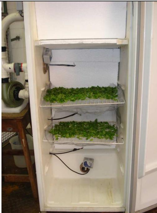
Figura A 13. Câmara de secagem da bomba de calor
