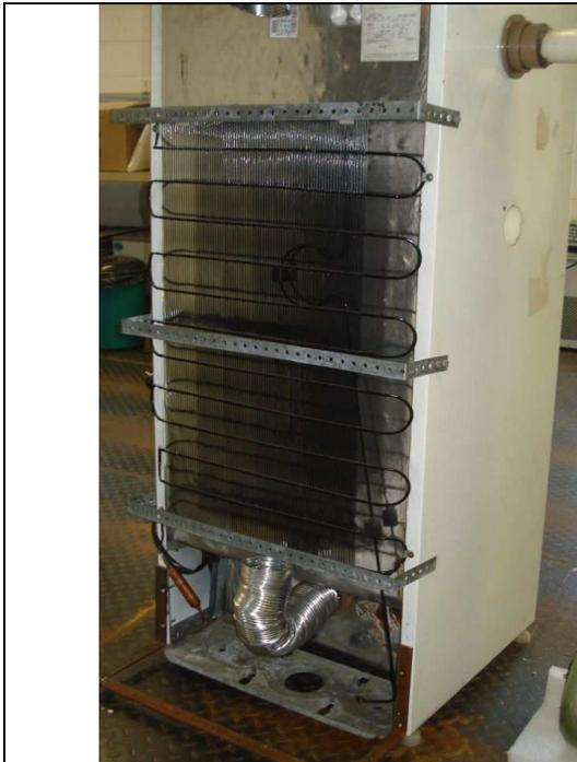
Figura A 1. Condensador no início da montagem
