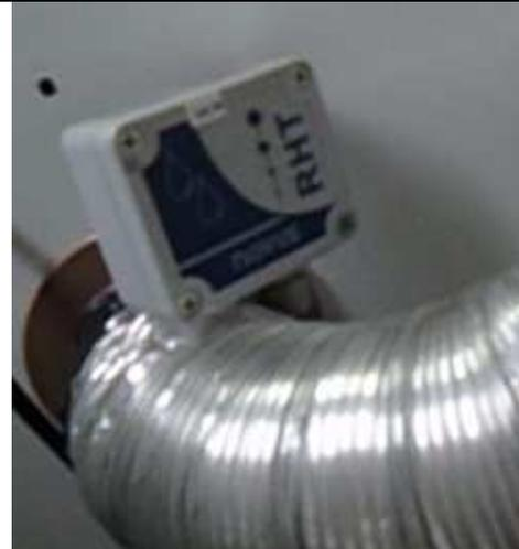
Figura A 12. Transmissor de umidade e temperatura instalado após o evaporador
