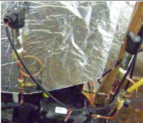
Figura A 11. Transmissores de pressão instalados nas linhas de sucção e descarga
