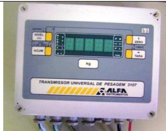
Figura A 4. Transmissor de pesagem utilizado nos experimentos
