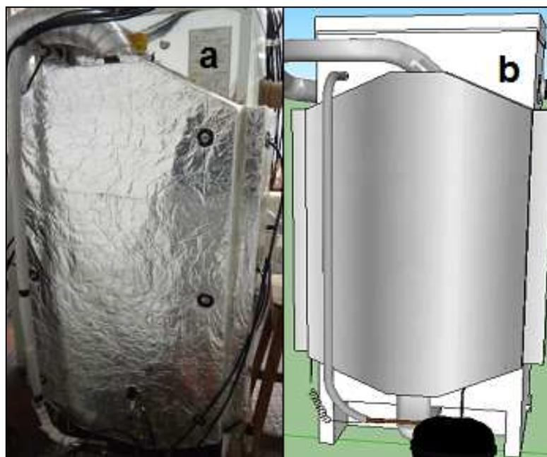
Figura 10. Coifas construídas para distribuição de ar e isolamento do condensador (a- foto original; b- esquema de montagem).
