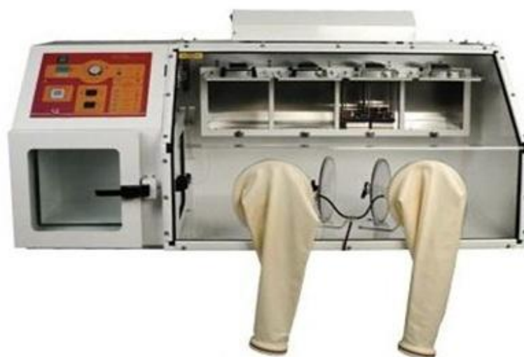
Figura 5. Câmara de anaerobiose Shell lab™, modelo Bactron II Chamber utilizada nos experimentos.
